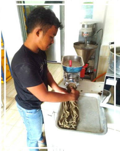
Rajah 7: Adunan yang telah disejukan dimasukkan ke dalam mesin pengisar daging bagi mendapatkan bentuk pallet yang memanjang.
