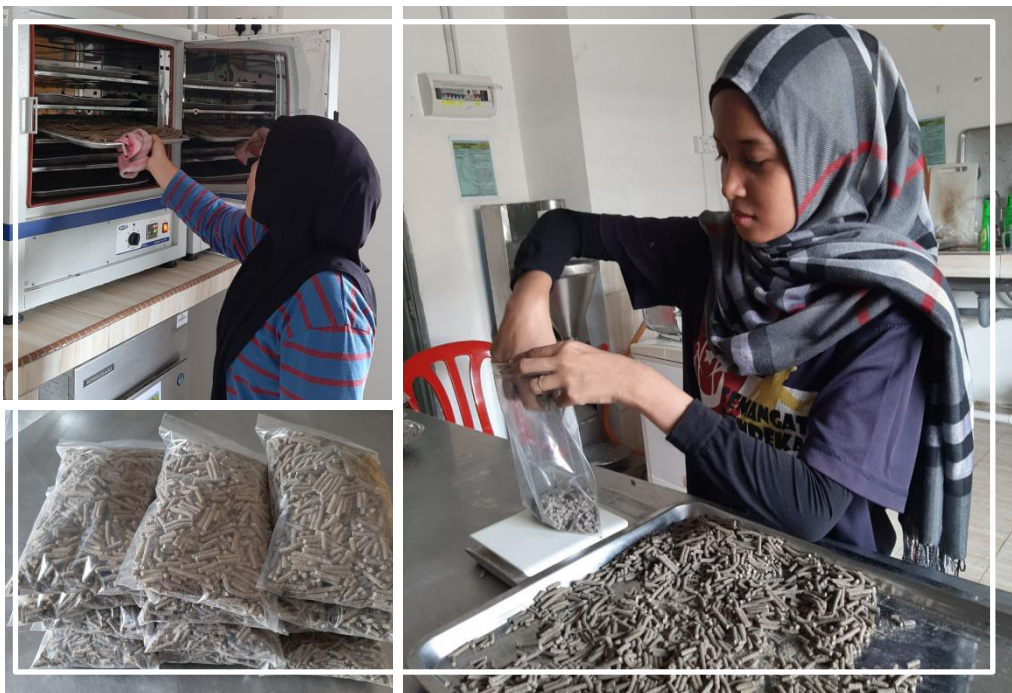
Rajah 8: Pallet yang siap dibentuk dimasukkan ke dalam drying oven untuk dikeringkan, proses seterusnya pallet yang telah siap akan ditimbang, dibungkus dan dilabel.
