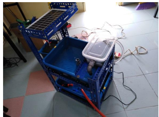
Langkah 1: Memasang Kerangka, Tangki & Sistem Akuakultur Pengaliran Air Semula (RAS)
