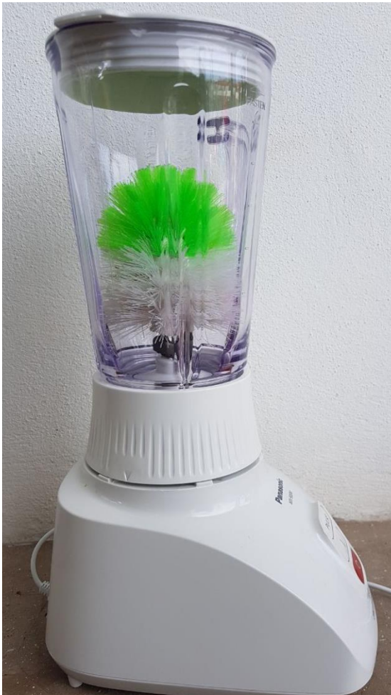
Mesin Pencuci Kunyit yang diubahsuaikan daripada fungsi mesin pengisar
